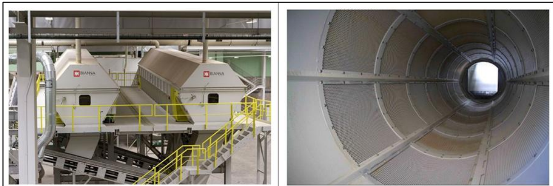
圖 1.2-3 滾筒篩示意照片
