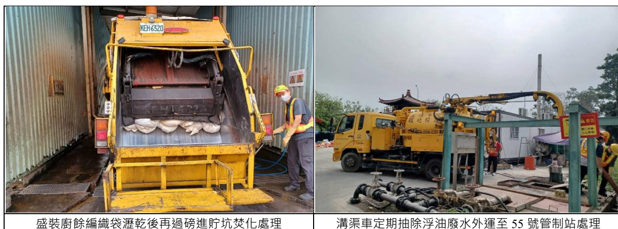
圖 3.1.1-1 廚餘瀝乾後倒焚化廠貯坑作業情形
